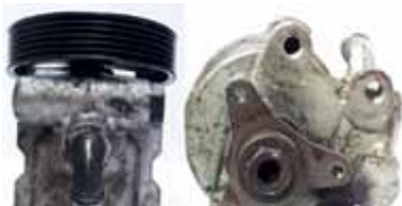
Aucun endommagement de la poulie ou du moyeu
