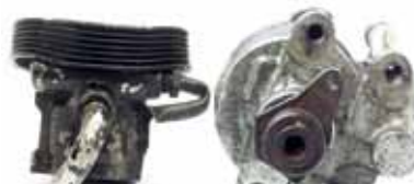
Riemenscheibe und Nabe sind beschädigt
