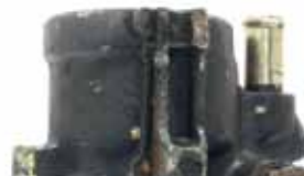
Der Montagegriff ist beschädigt
