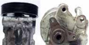
Unidades sin daños en la polea ni el cubo
