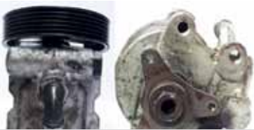
Ingen skade på remskive eller nav
