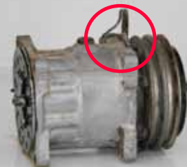
Al compresor le falta el conector o la valvula
