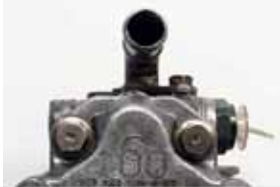
Aucun endommagement des branchements
