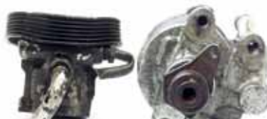
Unidades con la polea dañada y el cubo roto
