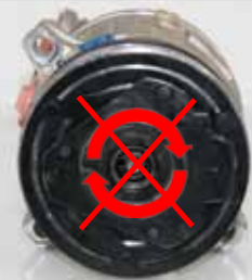
Navet (ikke remskiven) kan ikke dreje
