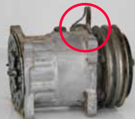
Enheden mangler stik eller ventiler
