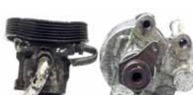
La poulie est endommagée et le moyeu est cassé
