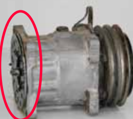
Compresores a los que les falte el soporte trasero
