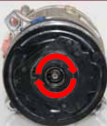
Aquellas unidades cuyo cubo (no la polea) puedan girar en ambos sentidos
