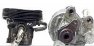
Remskive beskadiget og navet er knækket
