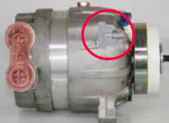
Hus eller ophæng beskadet
