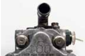
Ingen skade på tilslutninger
