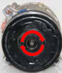
Navet (ikke remskiven) kan dreje både med og mod uret
