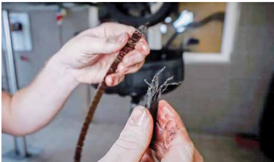
Pretrgan jermen za pogon oljne črpalke motorja VW TDI. Nenehen stik z oljem povzroča korozijo materiala jermena.
