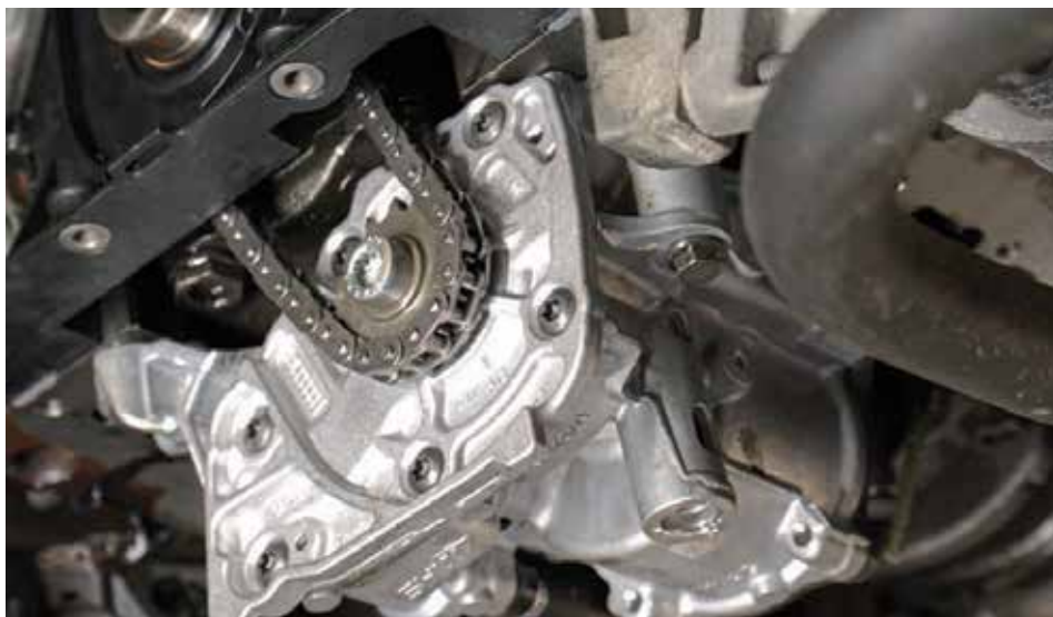
Ni več kritična točka – zamenjana oljna črpalka z verižnim pogonom podjetja MIK kot nadomestilo za zobati jermen.
